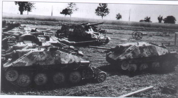
Vrakoviště u Nového Města na Moravě. Zajímavé je betonové zesílení horní části čelního pancíře u samohybného děla StuG 40 dole. (VHA) Sturmgeschütz 40 in a scrapyard near Nové město na Moravě. Note concrete reinforcement of the upper part of its frontal armour.
