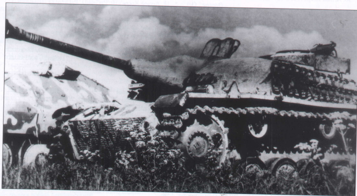
Vrakoviště u Nového Města na Moravě. Zajímavé je betonové zesílení horní části čelního pancíře u samohybného děla StuG 40 dole. (VHA) Sturmgeschütz 40 in a scrapyard near Nové město na Moravě. Note concrete reinforcement of the upper part of its frontal armour.
