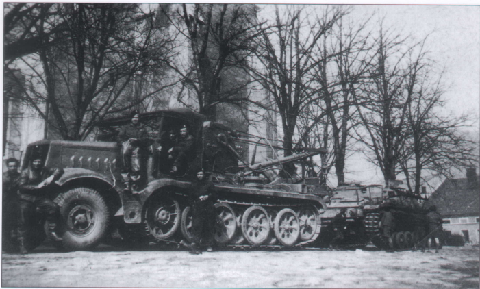
Czechoslovenské FAMO Sd Kfz 9/1 při odklizení vraku samohybného děla StuG III v Hroznětíně u Karlových Varů. (F. Mareš) A Czechoslovak FAMO Sd Kfz 9/1 tows away the wreckage of a StuG III in Hroznětín near Karlovy Vary.
